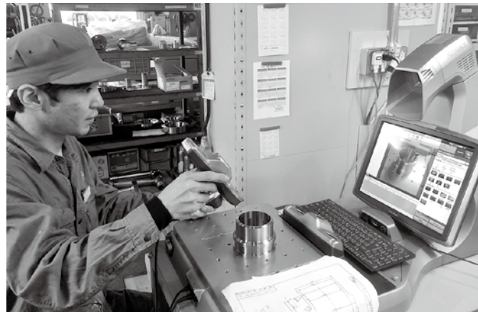
最新の三次元測定機の導入で精密に複雑な形状を測定 信頼性アップで生産・販売力の向上
