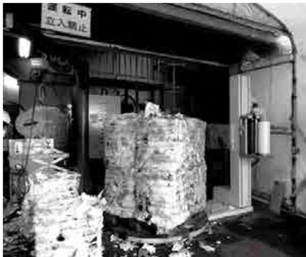
プラスチック減容固化装置で固化処理したもの
