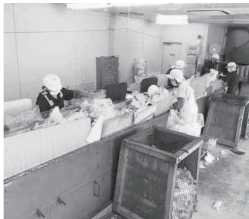
容器包装プラスチックは、2度の手選別作業を経て圧縮保管され業者へ渡るが、汚れが付着した物は悪臭を放ち焼却処分される
