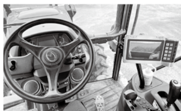
自動操舵装置はハンドル操作なしで正確な作業が誰にでも可能に
